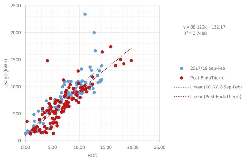
Die Grafik auf der vorigen Seite ist ein Beispiel für die bei USK F durchgeführte Analyse. Der Verbrauch im Zeitraum nach der Analyse wird mit einem prognostizierten Wert verglichen, der auf dem HDD-Wert für jeden Tag basiert, der in die Referenzlinie der Referenzlinien in Form von  $(y=mx+c)$  eingegeben wurde.
